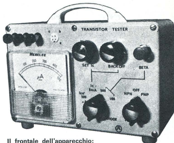
Il frontale dell'apparecchio: a sinistra lo strumento per la lettura, a destra tutti i comandi.
